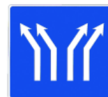
S-63 Bifurcación en calzada de cuatro carriles
