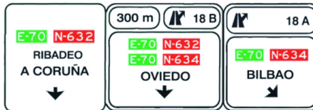
S-371 Señales sobre calzada en carretera convencional, dos salidas inmediatas hacia carretera convencional y dirección propia
