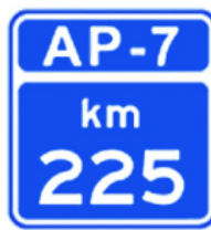
S-570a Hito kilométrico en autopista de peaje
