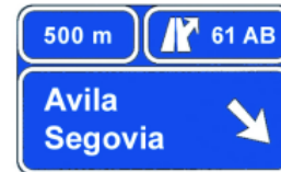
S-242 Preseñalización en autopista o autovía de dos salidas muy próximas hacia cualquier carretera
