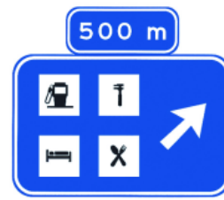
S-263a Preseñalización en autopista o autovía de una zona o área de servicios con salida exclusiva
