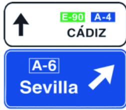
S-222a Preseñalización de direcciones hacia una autopista o una autovía y dirección propia
