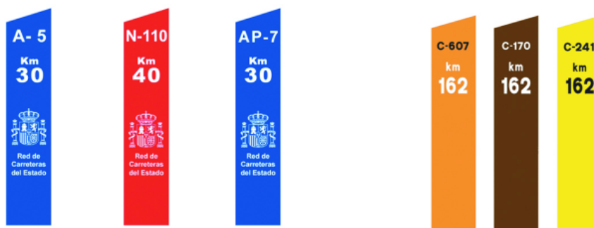
S-574 S-574a S-574b Hito miramétrico en autopista, autovía, carretera convencional y autopista de peaje
