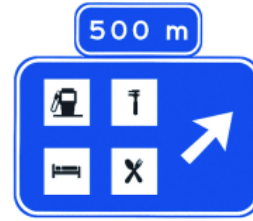
S-263a Preseñalización en autopista o autovía de una zona o área de servicios con salida exclusiva
