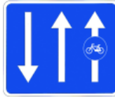
S-64 Carril bici o vía ciclista adosada a la calzada
