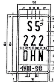
Matrícula ciclomotore temporal empresas (Vehículos no matriculados) Fondo rojo. Caracteres blanco mate Banda: Fondo blanco. Caracteres rojo mate adhesivos
