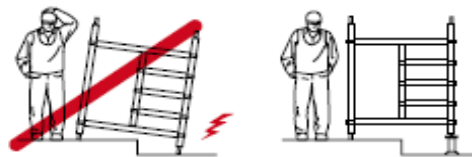
Si el sòl és irregular, s'utilitzaran les potes regulables (sense rodes).
