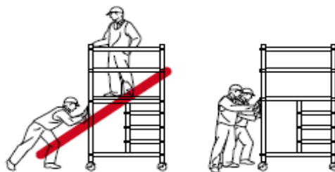
No es permet traslladar al personal damunt la bastida. El desplaçament de la bastida s'efectuarà entre dues persones.
